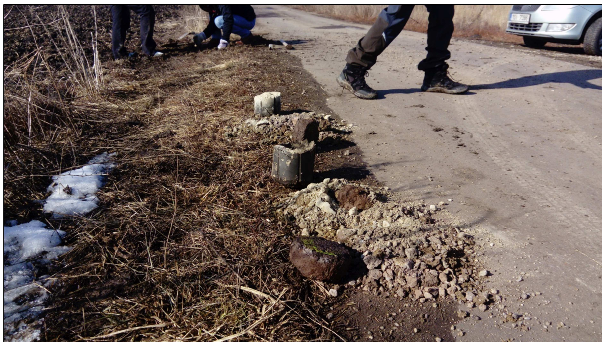
Foto 7: Výsledek návrtu v místě penetrací na „1. větví“ komunikace (2. část, u bývalého státního statku).
