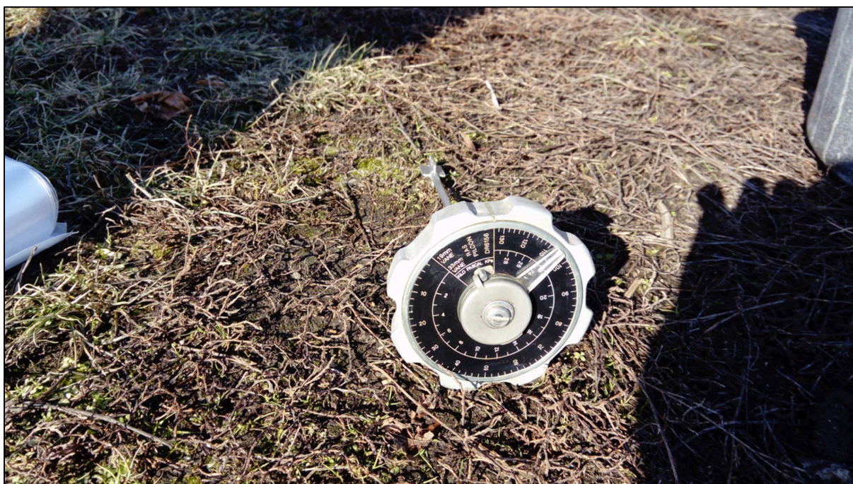
Foto 15: Detail mini-vrtulkové zkoušky pro přibližné stanovení neodvodněné pevnosti.
