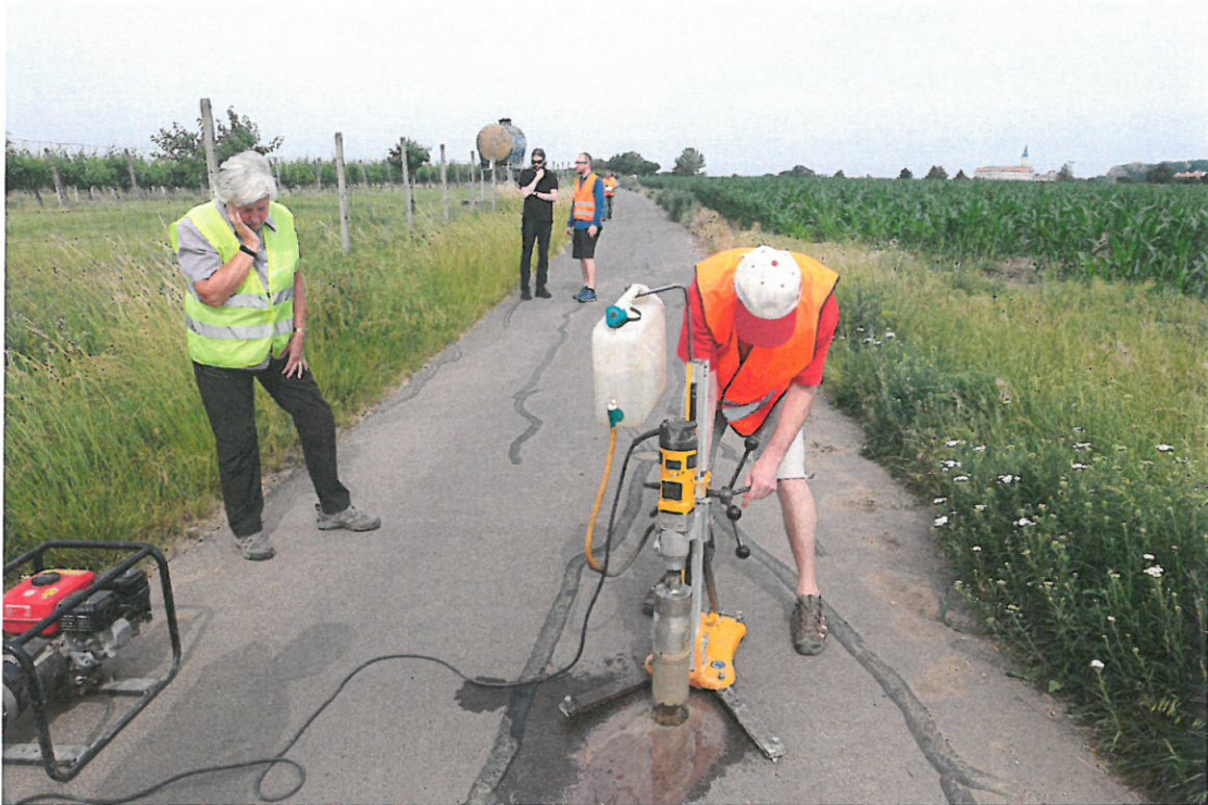
Obrázek P1 – Jádrový vývrt J.V. 1 průměru 100 mm, výběr místa po souhlasu všech zúčastněných stran
