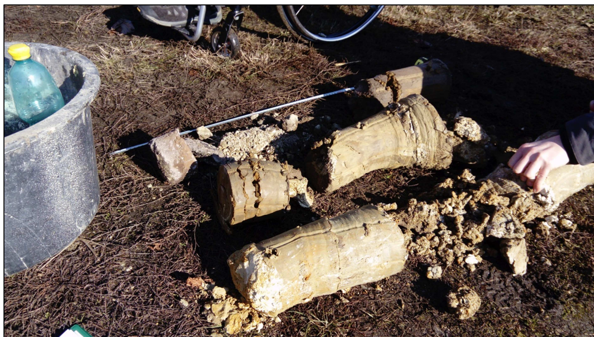
Foto 17: Dokumentace vrtu v počátečních staničních komunikace. Ornice zcela chybí, je jednoznačně patrné stlačení jádra neogenního jílu třídy F6/F8 – jak vrtáním, tak vlivě následného vytlačování stlačeným vzduchem a impaktem o povrch komunikace.
