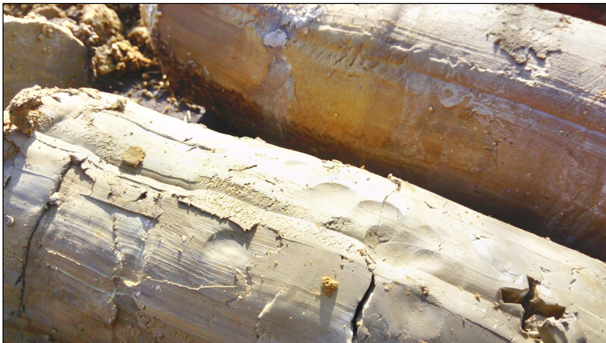
Foto 11: Otisky prstů znalce dokumentující měkkou až tuhou konzistenci neogenního jílu.
