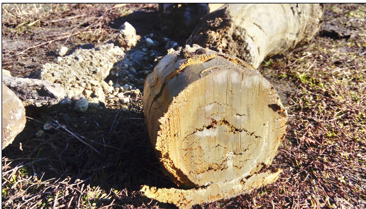
Foto 14: Jíly třídy F6, místy F4, patrné je limonitové smoubování a přítomnost sádrovce. Není patrná žádná známka úpravy vápenocementovou stabilizací.
