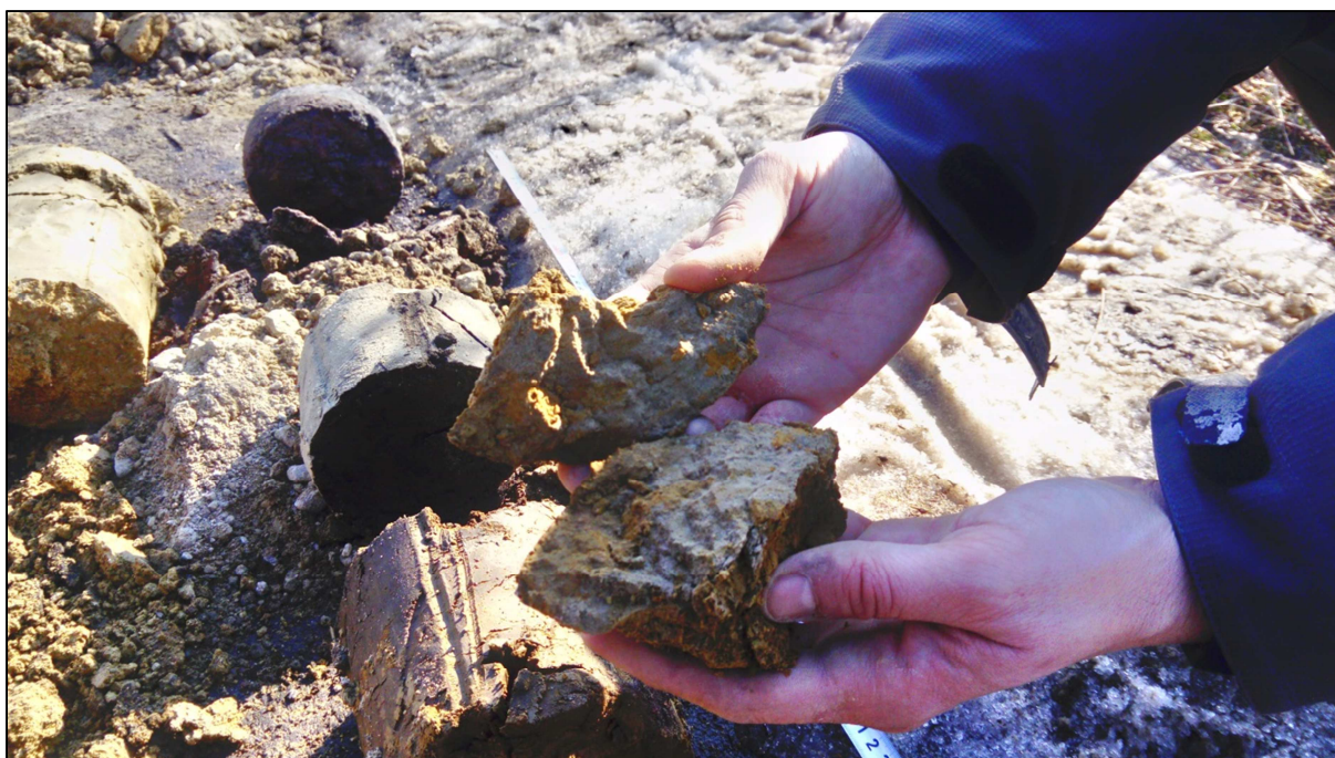
Foto 10: To samé místo, z jiného pohledu. Pod asfaltovou zátokou je opět patrný makadam a níže poloha ornice – stlačena na délku jádra přibližně 15 cm z původní průměrné mocnosti ornice v oblasti 0,25 – 0,3 m.
