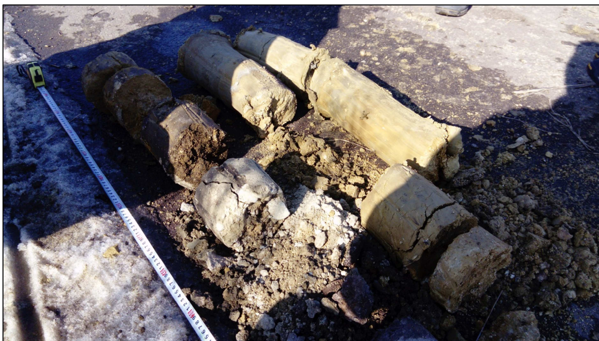
Foto 9: Fotografie dokumentace průzkumného jádrového vrtu 3m dlouhého jen několik desítek metrů od místa zachyceného na Foto 7 a Foto 8. Jasně patrné je stlačené jádro v úrovni 2-3 m, které je dáno konzistencí neogenního jílu třídy F8. Vrtání proběhlo „nasucho“, tj. jádra nebyla ovlivněna výplachem.
